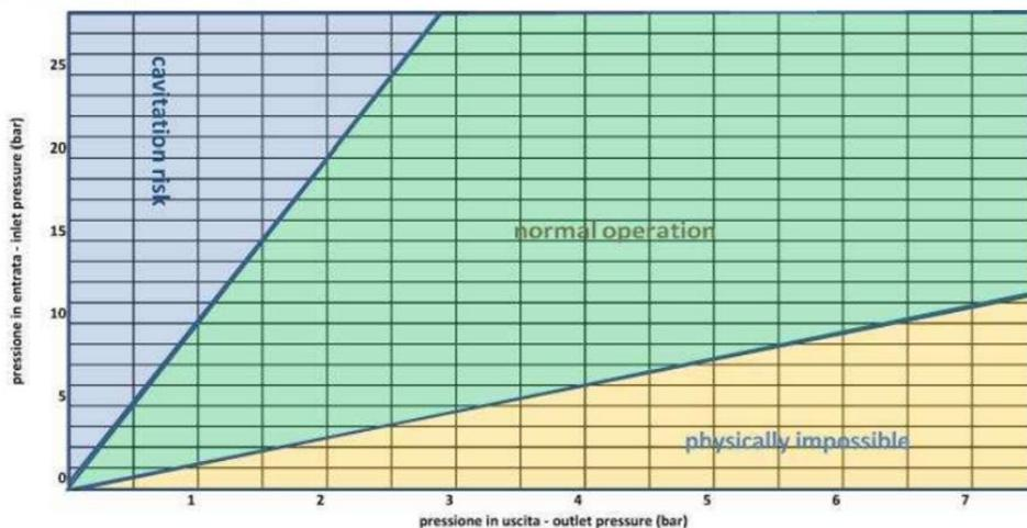
Esempio di calcolo: valore di pressione a monte 8 bar, valore di pressione a valle 4 bar, rapporto di pressione 2:1.
